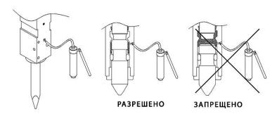
При смазке гидромолот должен быть расположен вертикально к поверхности с опорой на рабочий инструмент. Т.е. пика задвинута внутрь механизма гидромолота и прижата к поршню (бойку), во избежание попадания смазки между поршнем и рабочим инструментом, что может привести к отказу гидромолота.
